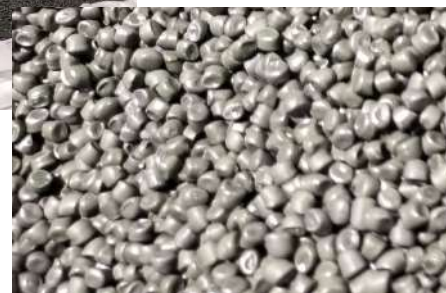
臭気を取り除いたペレットにより、処理量の拡大と評価の安定をはかる
