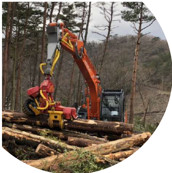
ハーベスタによる伐採・造材・集積風景
