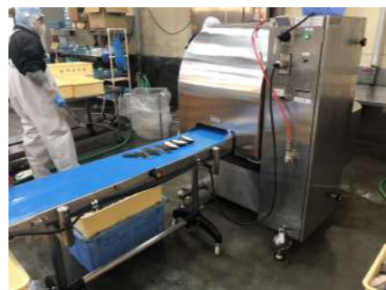
数値制御と画像認識により、どのような部位でも同じ重量にカットできる
