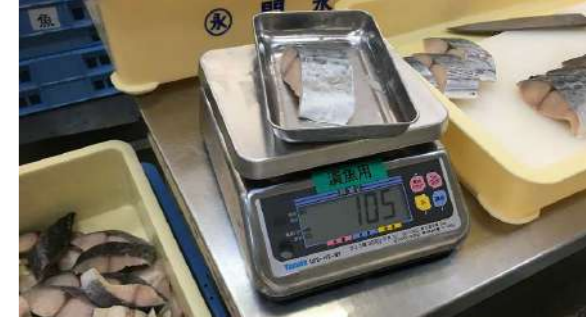
数値制御と画像認識により、カット重量の誤差は、±5g以内
